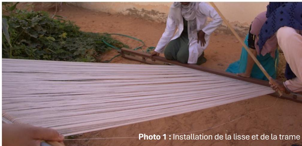
Photo 1 : Installation de la lisse et de la trame
